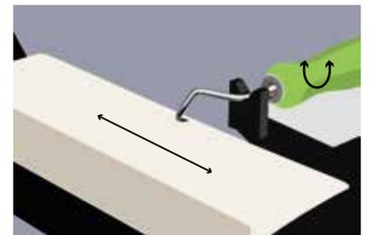
Für **Dentalinstrumente anderer Hersteller** empfehlen wir das Erstellen einer eigenen Tabelle: Stellen Sie hierzu den Winkel beim ersten Mal „mittels Augenmaß“ ein. Färben Sie dann die Klinge (z.B. mit Filzstift) ein und führen Sie eine Schleifbewegung durch. Wird die Farbe dadurch entfernt, so ist der Winkel zum weiteren Schleifen dieses Instruments geeignet.
